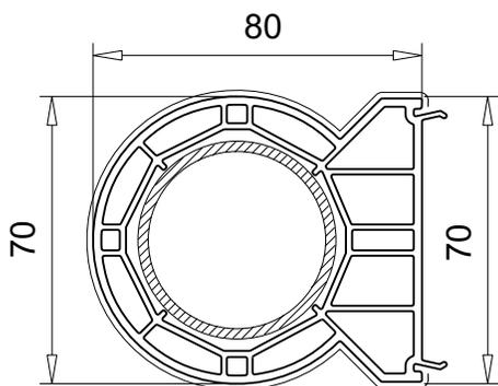
круглый соединитель с изменяемым углом
