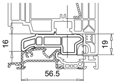
расширитель (для обычной и дверной створки)
