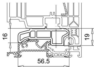
расширитель (для обычной и дверной створки)
