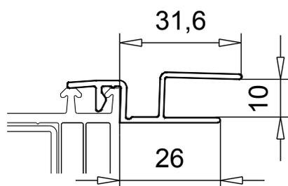
стыковочный профиль (для отделки откосов с изменяемым углом)
