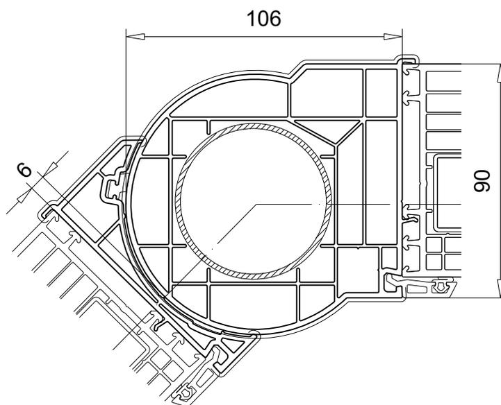
круглый соединитель с изменяемым углом
